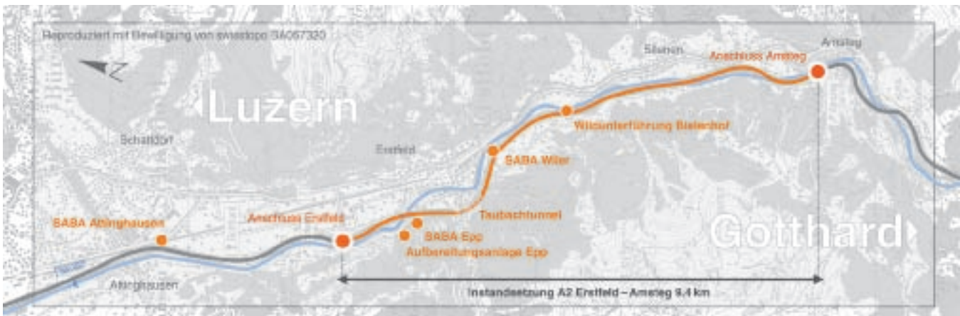
Die Erneuerung der A2 zwischen Erstfeld und Amsteg: Die Fahrbahn wird komplett erneuert und die Kunstbauten werden saniert. Zudem erhält die A2 drei neue Strassenabwasserbehandlungsanlagen sowie eine Wildunterführung im Bielenhof.
