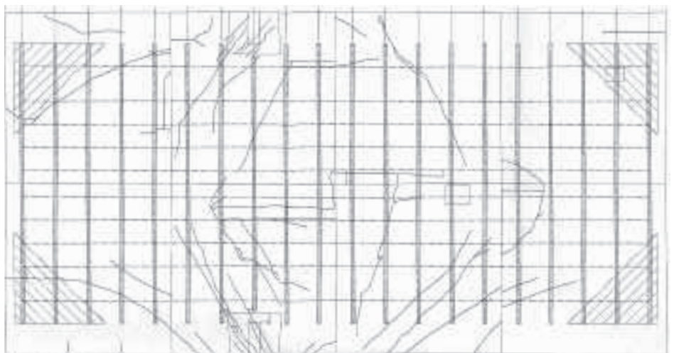
03 Tunnelgewölbe in der Schadenzone: Rissbild der Innenschale im Scheitelbereich und Lage der Stahlsegmentbögen
