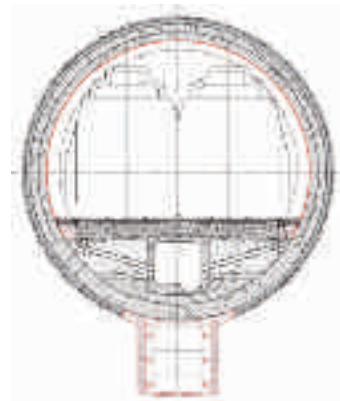
06 Tunnelquerschnitt des Projekts «EAGLE ONE» mit Entlastungsstollen und tangentialen Entlastungsbohrungen unter der Tunnelsohle (2. Preis: IG Lombardi / Henauer Gugler, Luzern)
