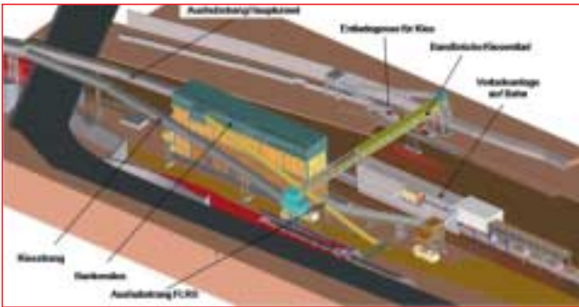
10 3-D Gesamtübersicht der Logistikanlage
