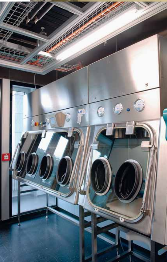
Diese Werkbank dient dem Schutz des Arbeiters und der Umwelt beim Umgang mit Organismen der höchsten Risikogruppe (Risikogruppe 4). (Bild: Basler & Hofmann)
