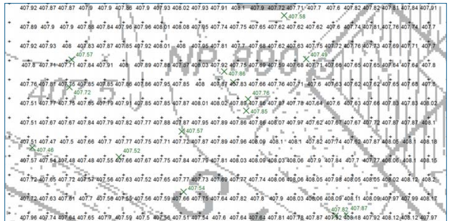
Bild 5. Ausschnitt des auf 3×3 m 2 gerasterten DTM (schwarz, •) und Schachtdeckelkoten (grün, X). Bereich Einmündung Dufourstr./ Bellerivestr. (vgl. Bilder 1–4). Der Ausschnitt entspricht (70×35) m 2 .
