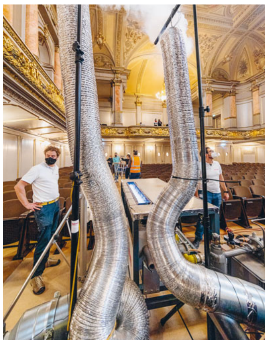
Sicherheitsnachweis in der Grossen Tonhalle Zürich mit der Heissrauchanlage Izar von Basler & Hofmann.
