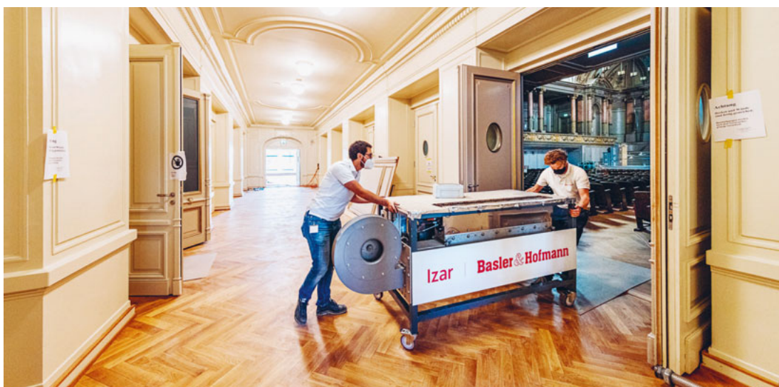
Die Heissrauchanlage Izar wird in die Grosse Tonhalle gefahren.
